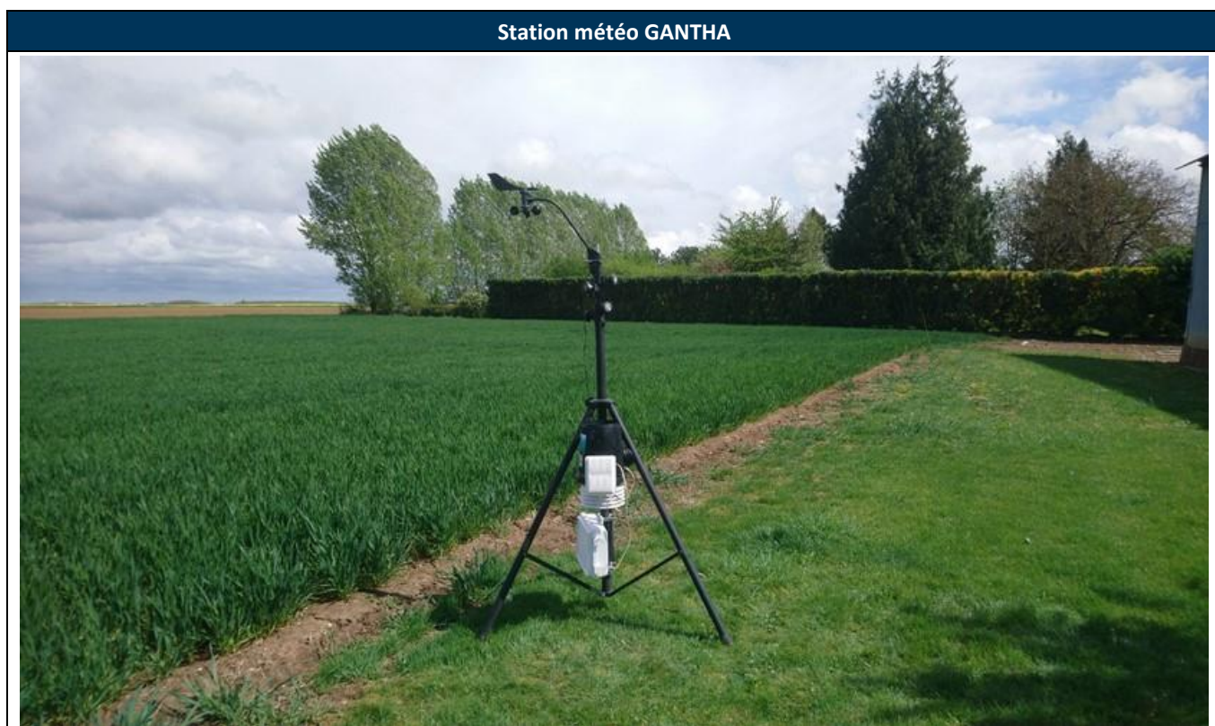
Figure 2 : Station météorologique sur pied à 1,5 m du sol
